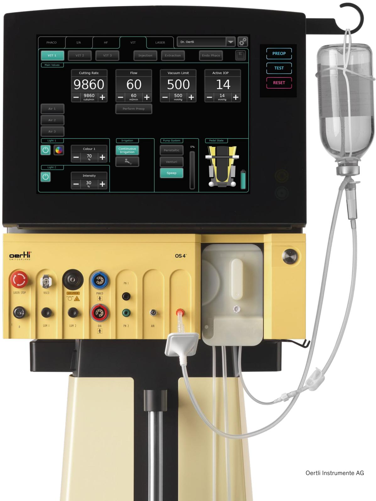
Le système à trois pompes constitue le cœur de la plateforme, avec contrôle du vide et du flux, ainsi qu'une pompe SPEEP innovante permettant la maîtrise simultanée du flux et du vide. La plateforme OS 4 utilise ainsi les lois de la physique pour rendre la chirurgie de l'œil encore plus sûre, plus simple et plus efficace.
