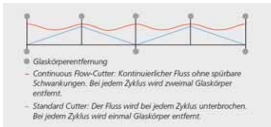
Abb. 3: Hohe Effizienz des Oertli CF-Cutters.
