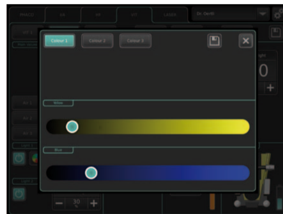
Abb. 2: Das Goodlight LED beim OS4 ermöglicht ein individuell einstellbares Lichtspektrum.
